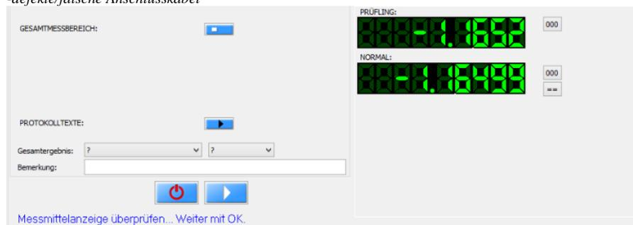
Im Normalfall ist das Schaltfeld Nullsetzen „000“ beim Prüfling nicht zu betätigen – besser die Taste am Prüfling selbst benutzen. Es ist sicherzustellen, dass der gesamte Prüfbereich (+ Vorlauf und Nachlauf) am Prüfling elektronisch und mechanisch erreichbar ist und die Messrichtungen von Prüfling und Normal identisch sind!
