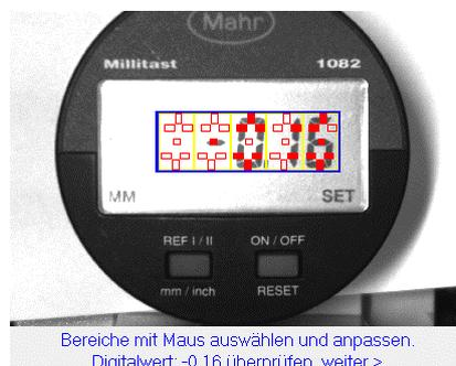
Es besteht auch die Möglichkeit einer automatischen Suche. Dazu muss der Messbolzen anliegen, damit die Software kleine Displayänderungen während einer kurzen Bewegung erkennen kann.
