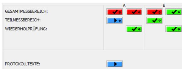
Für jeden Prüfschritt stellt das Programm ein farbiges Schaltfeld dar. Dieser entspricht dem aktuellen Prüfergebnis, kann aber auch zum Start/Wiederholen von einem Prüfschritt verwendet werden. Die Pfeile symbolisieren die Messung mit „hineingehendem“ bzw. „herausgehendem“ Messbolzen. Bei Messmitteln mit 2 unabhängigen Messungen (z.B. Fühlhebelmessgeräte) werden die Prüfschritte von A und B dargestellt.
